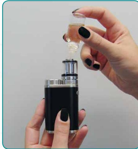
Diese „Verdampfer“ basieren auf der Technologie, mit der in Diskotheken Nebel erzeugt wird. Seit 2007 wird diese Art der elektrischen Zigaretten weltweit hergestellt und vertrieben. In jedem Verdampfer befindet sich ein Verdampferkopf mit einer oder mehreren Heizspiralen, welche von einem Akku mit
