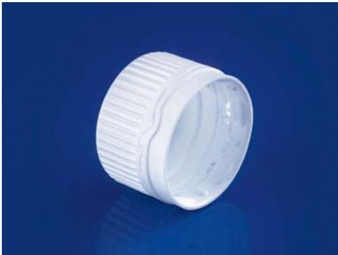
Standard Ausführung des Originalitätsverschlusses OVI-28. Multikonus dichtet verschiedene Flascheninnenmündungsdurchmesser von 19,3-21,7 mm zuverlässig ab.
